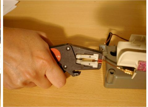
Streifen Sie die Kabel mit dem Kabelabstreifer ab.
