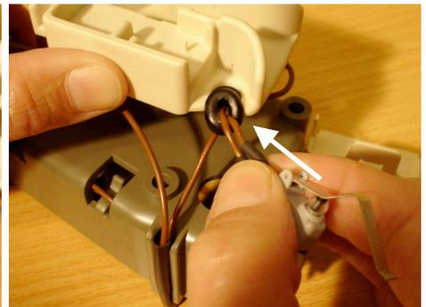
Stecken Sie die Kabel wieder in das Gehäuse
